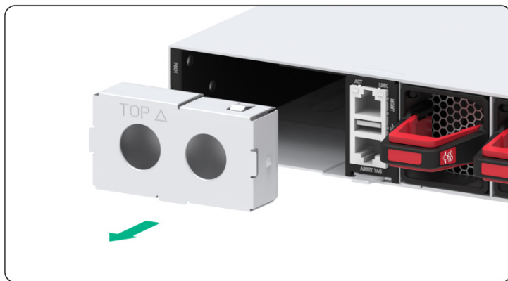
图2-21 电源假面板拆卸示意图
